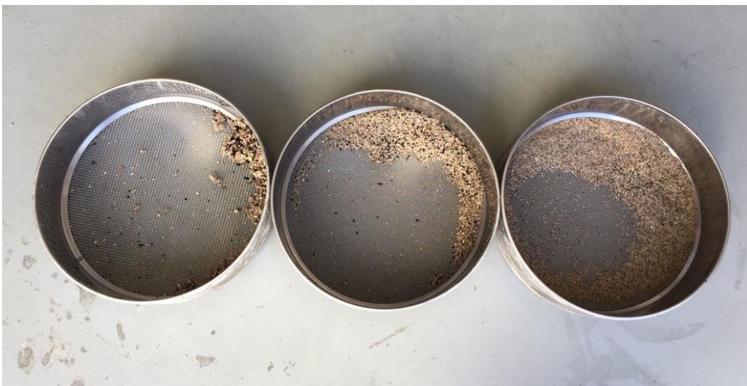
Figura 5. Separació de diàmetre de partícula mitjançant filtratge de sediments en tamisos de 2, 1 i 0,5 mm..
